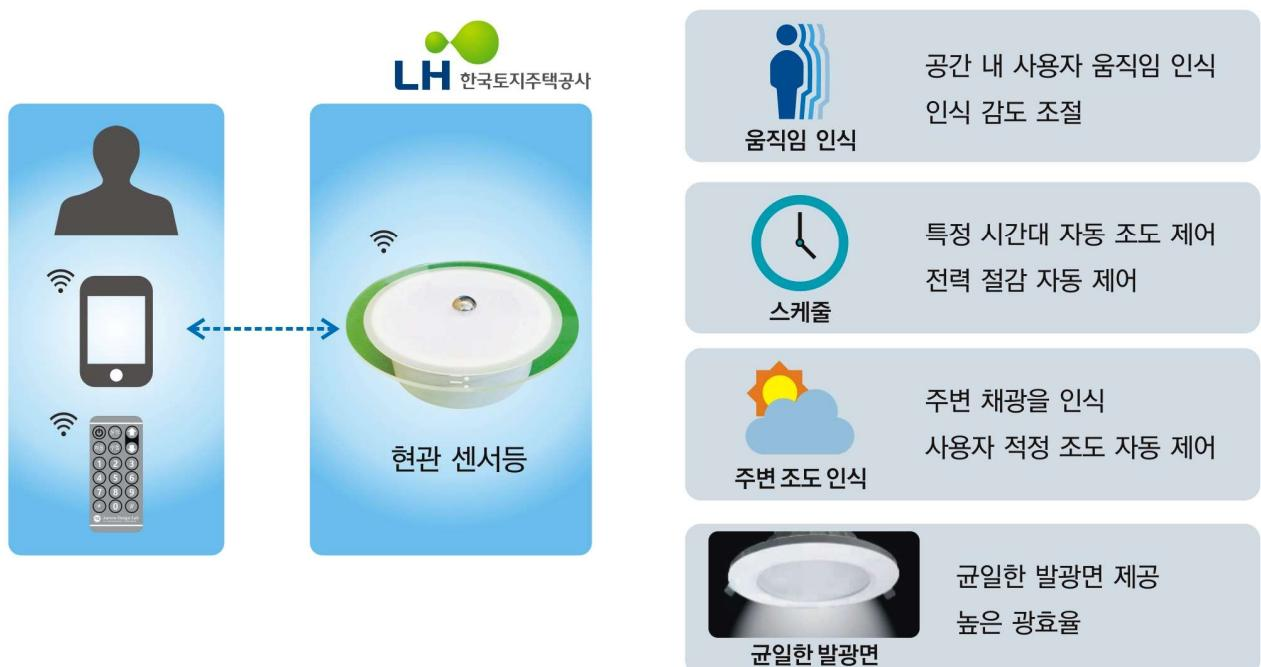
\* 스마트 조명은 내장된 Smart Sensor에 의하여 동체가 감지되면 주변 조도와 스케줄에 따라 적합한 디밍 단계를 기억하고 자동으로 제어되며 동체가 미감지 시 자동으로 소등되어 에너지 절감의 극대화에 기여합니다.
